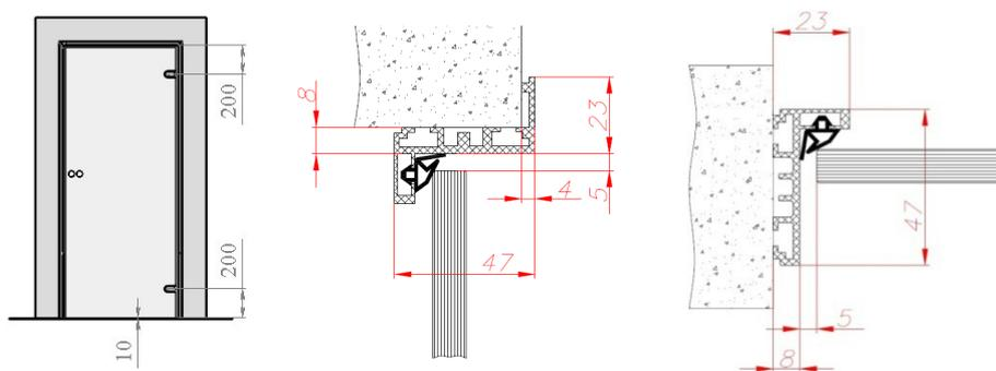
2. Установить на дверь замок и отметить на внутренней части коробки расположение ответной планки замка (по разметке сделать отверстие для свободного закрывания язычка замка). Закрепить ответную планку.
